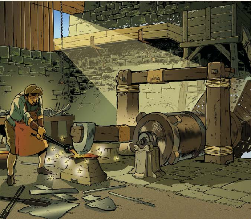
◀ Reconstitution d'une forge avec son martinet. Le Brevon fait tourner la roue à aube entraînant l'arbre à came qui soulève le martinet. La pièce de métal qui battait le fer est conservée au Musée de l'Histoire et des Traditions de Bellevaux.
